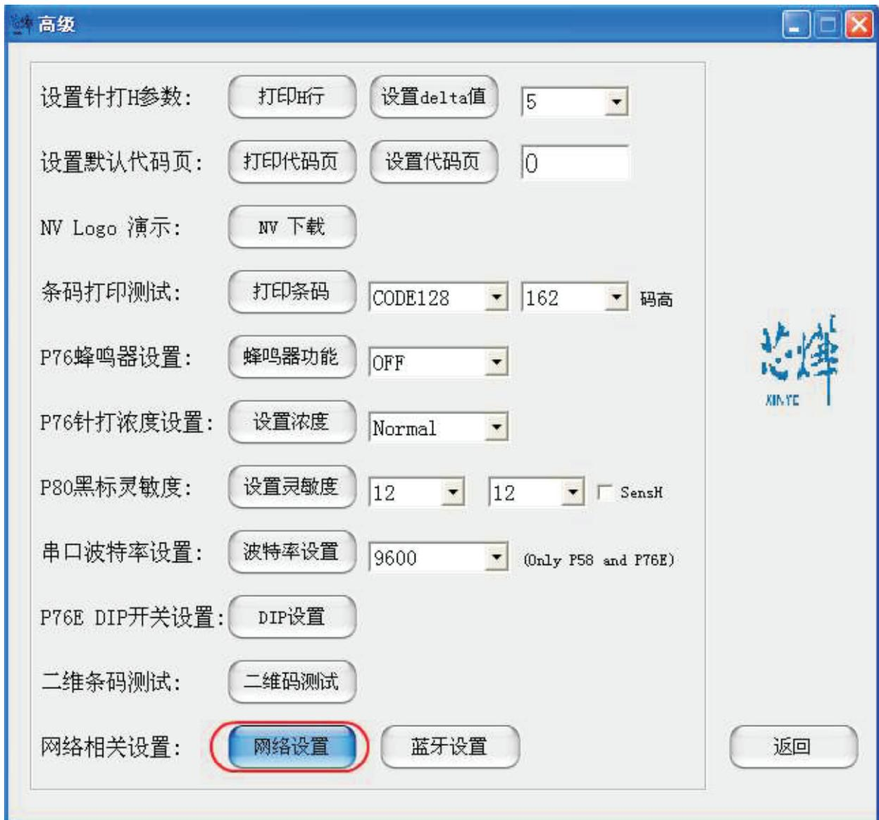
点击“网络设置”弹出相应的网络设置窗口，按步骤设置打印机网络设置（如下图）
